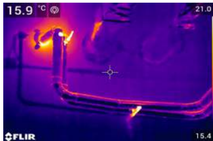
Tubazioni isolate a parete da proteggere con involucro
